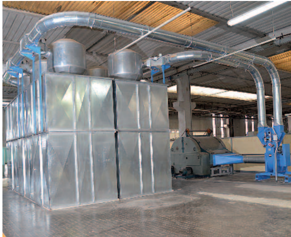
Serbatoio fibre per alimentazione automatica carda Fibres tank for automatic feeding carding machine
