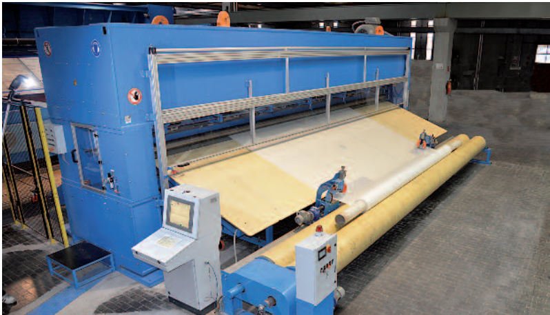
Preagugliatrice mt. 8,20 di larghezza utile con movimento ellittico di agatura. Pree-needle loom mts. 8,20 width with ellipitcal needling
