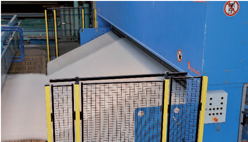
Preagugliatrice mt. 8,20 di larghezza utile con movimento ellittico di agatura. Pree-needle loom mts. 8,20 width with ellipitcal needling
